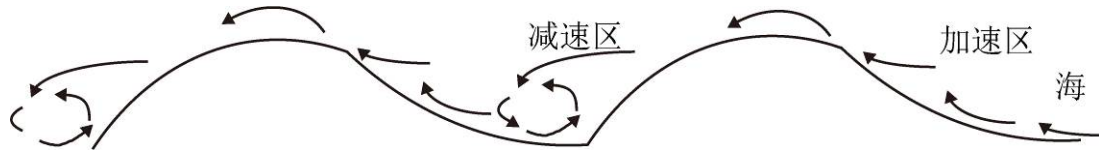
图 5.13 水质点在底床表面运动轨迹示意图
