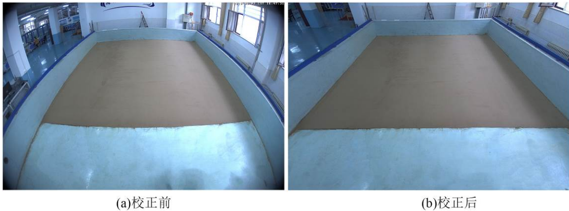
图 4.1 干潮滩图像畸变校正前后对比
