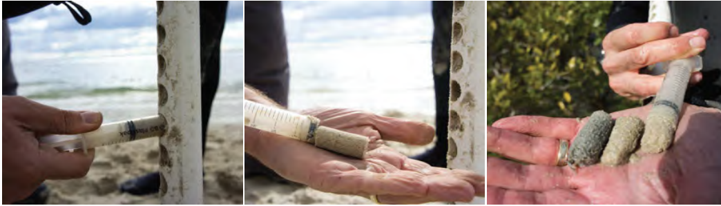
图 3.12 使用预先钻孔的土壤采样器和切割过的塑料注射器采集土柱示意 (© Sarah Hoyt, CI)
