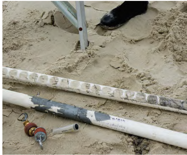
图 3.6 海草床的土壤取样器 PVC管、橡胶塞和针筒示意 (© CI/Sarah Hoyt)
