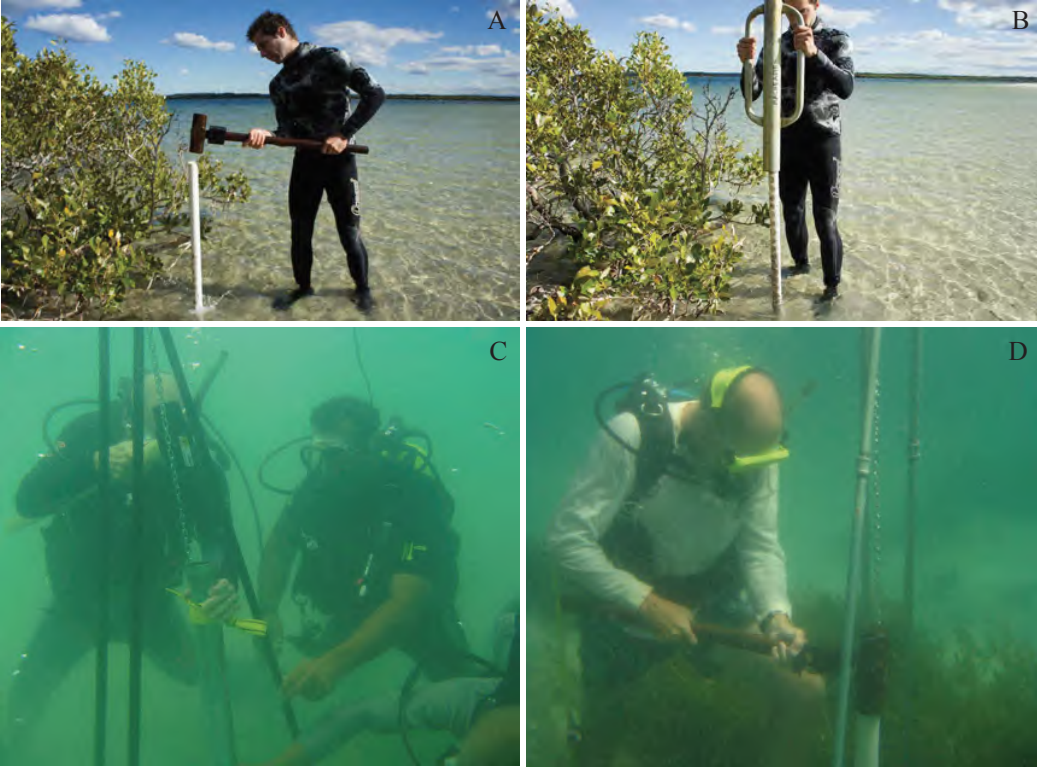
图 3.7 海草床土柱采样器压入示意
