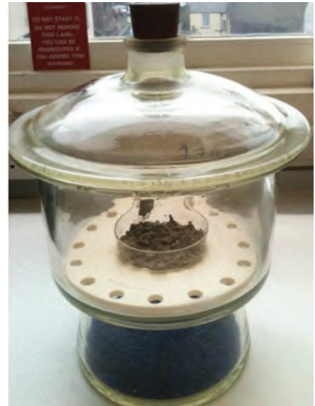
图3.18 土壤样品置于干燥器中冷却至室温 (© Hilary Kennedy, UWB)
