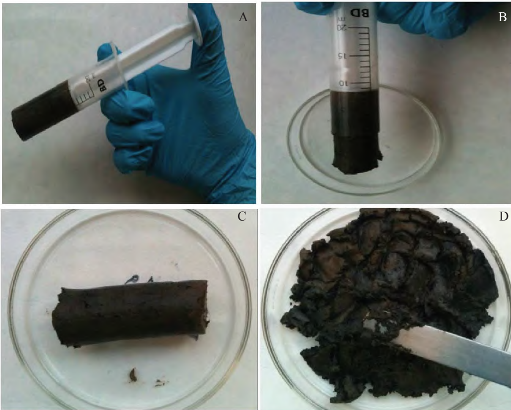
图 3.17 注射器中样品挤取和烘干准备示意
