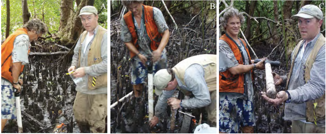
图 3.5 用土钻采集土柱示意 (A) 步骤一；(B) 步骤二；(C) 步骤三。(© Boone Kauffman, OSU)
