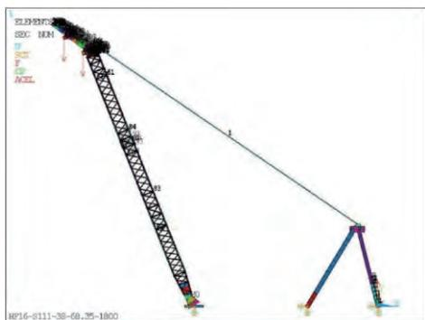
图1 臂架三维模型图
