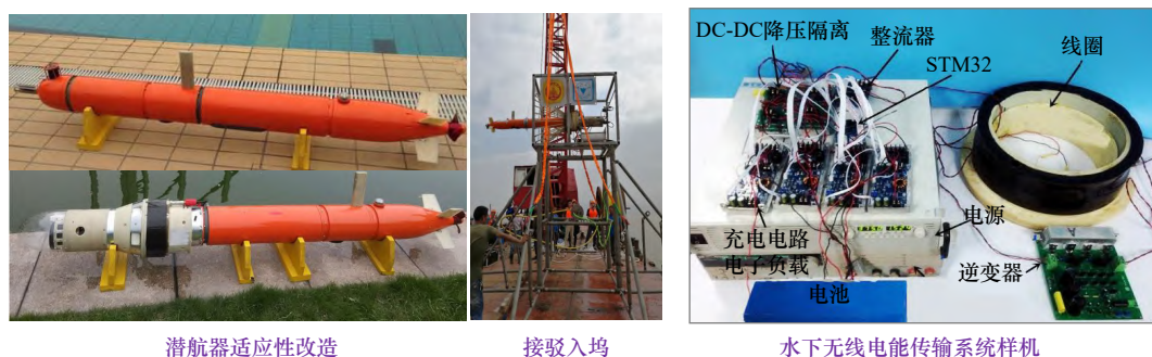
图 9 深海移动平台与海底观测网非接触接驳系统
