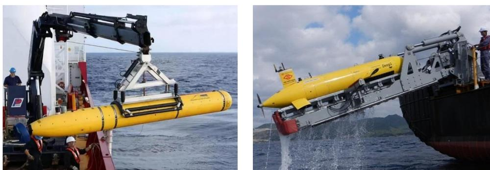
(a) AUV 吊放式回收装置
