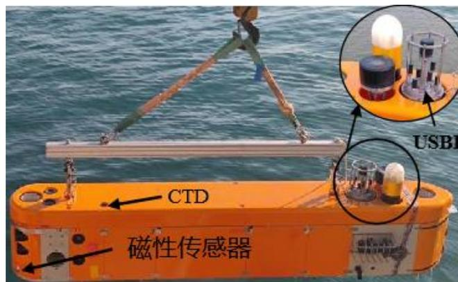
图 2.13 AUV 实物图
