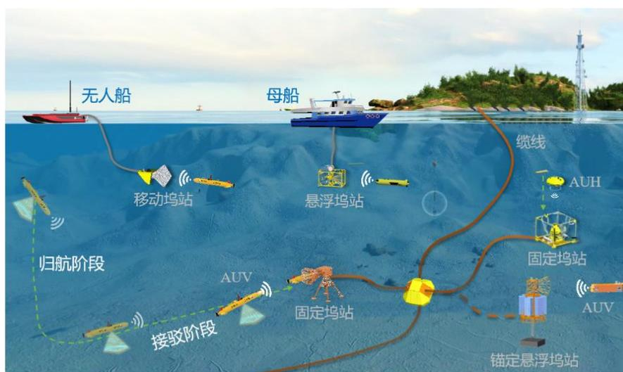
图 2.2 不同接驳坞类型的 AUV 接驳入坞场景
