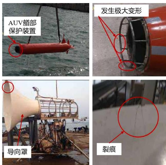
图 3.1 海测中接触碰撞造成的设备破损
