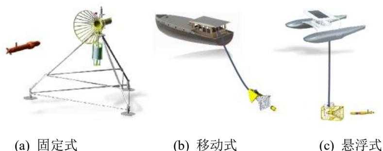
图 1.5 漏斗/锥形接驳坞的接驳方式
