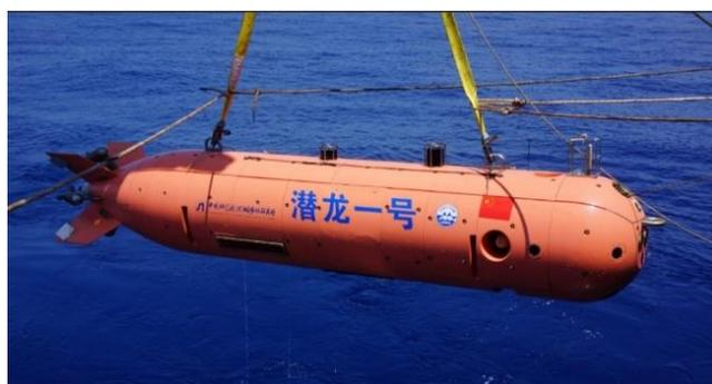
(b) 6000 米级“潜龙一号”AUV
