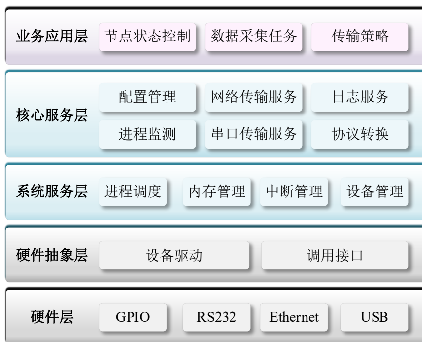
图 3.6 底层主观测节点软件结构
