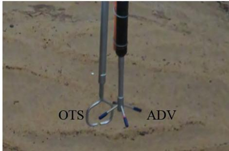
图 2 多普勒流速仪 (ADV) 和光学浊度仪 (OTS)
