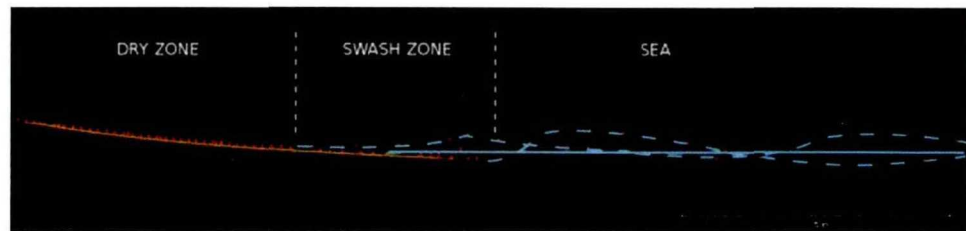
图5 平均海平面(蓝线)、不同时刻的海平面(蓝色虚线)和激光雷达测量点(红点)。
