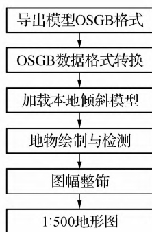
图6 地形图绘制流程
