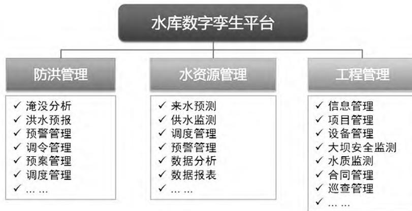
图2 水库数字孪生平台系统构成图
