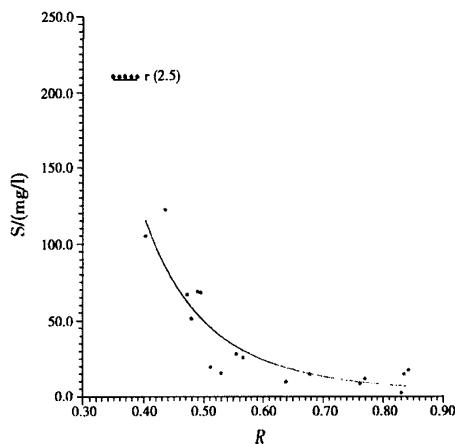
图 3 波长为 443 nm 和 555 nm 的反射率比值与海表面悬浮泥沙量的关系图
