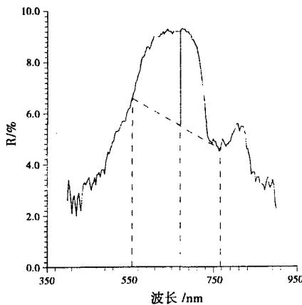
图 1 670 nm 的反射高度来遥感海面叶绿素原理图
