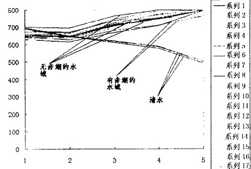
图 5 1997 年 11 月 2 日闽南微赤潮各样品点  $1 \sim 5$  波段的离水辐射率(图中, 横坐标为波段数, 纵坐标为离水辐射率:  $0.001 \text{ mW}(\text{cm}^2 \cdot \text{sr})$ )
