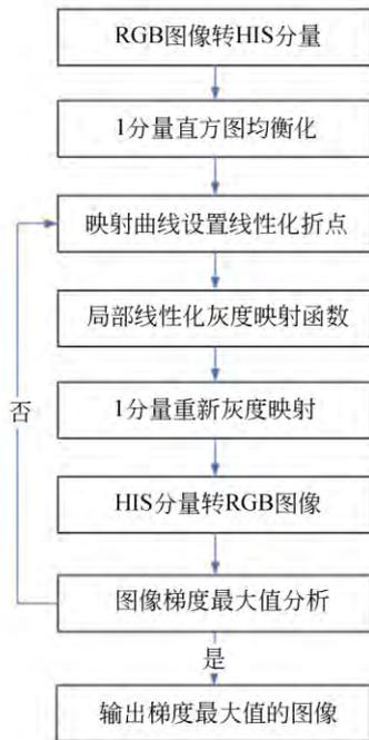
图 2 亮度直方图局部线性化图像增强算法流程
