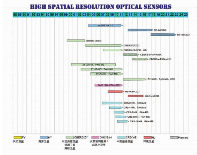
图8 装载高空间分辨率光学传感器的中国卫星计划
