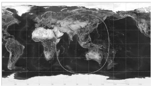
图1 风云四号 A 星观测范围图(来源:国家卫星气象中心<sup>[28]</sup>)
