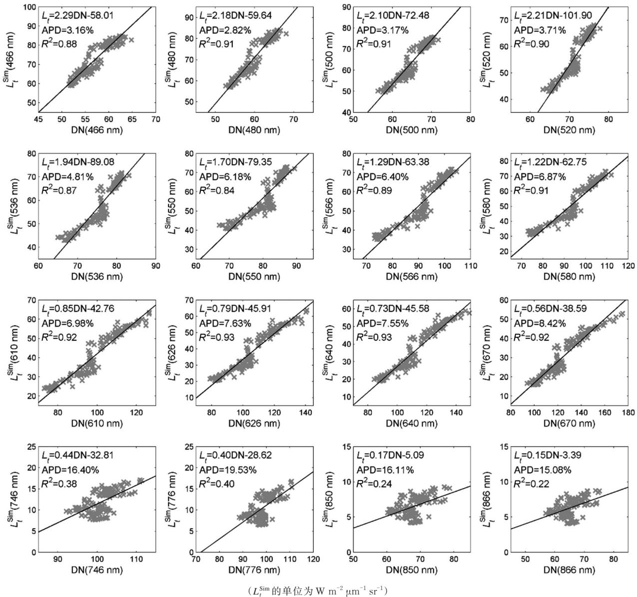
图8 OHS各波段模拟的 $L_t^{\text{Sim}}$ 与DN值的散点图
